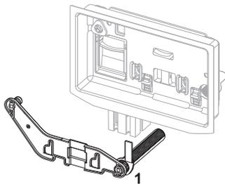
1 9820693 Tiges de guidage pour trappe d'insertion II
